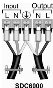
شکل ۲۲: اتصال کابل‌های ورودی و خروجی
